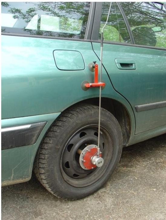
Abb. 3.3: Messfahrzeug mit montiertem Peiseler-Messrad
