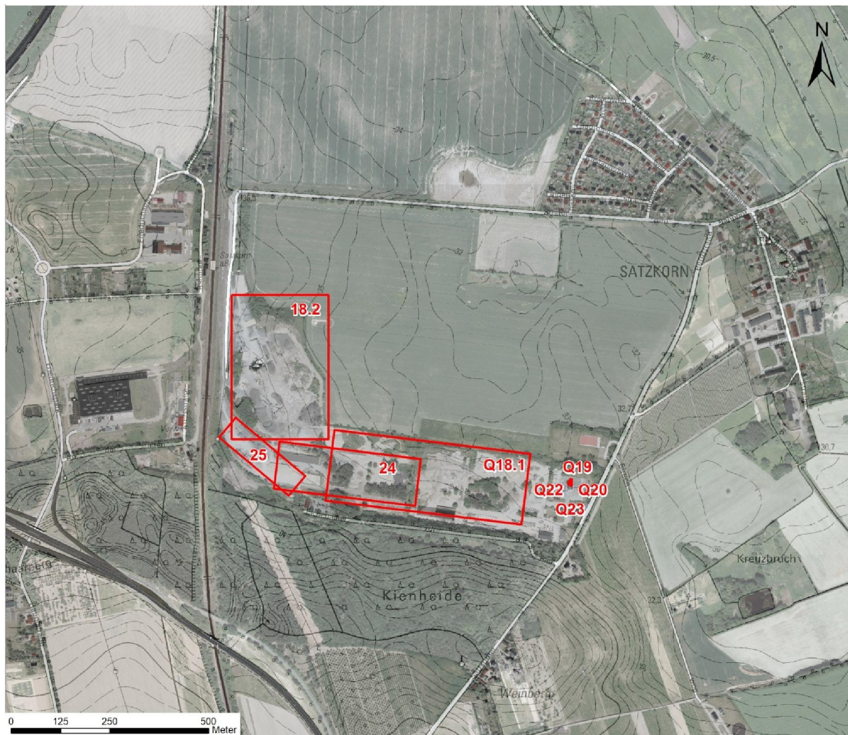
Abb. 3.1: Lage Untersuchungsgebiet mit Quellbezeichnung roter Punkt = Punktquelle, rote Vierecke = Volumenquellen Quelle Kartengrundlage: vom Auftraggeber
