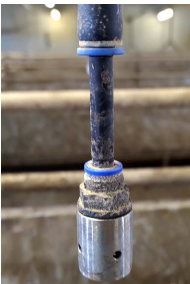
Bild 28: Befeuchtungseinheit der Mikrosuhle in der Modellbucht (© J. Schäler / LELF)
