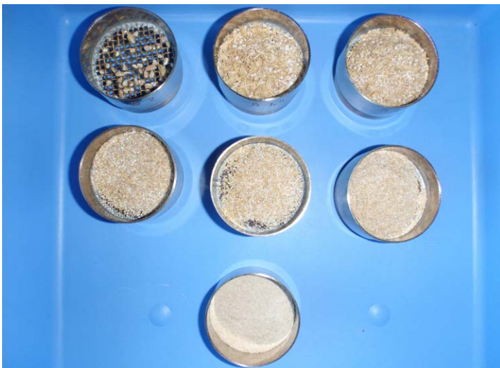
Bild 40: Trockensiebung der Futterkomponente Getreideschrot des Endmastfutters (© Dr. M. Böckelmann)
