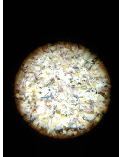
Bild 2: Ansicht einer getrockneten Fraktion mit einem Messmikroskop inklusive der Messskala (© Dr. M. Böckelmann)
