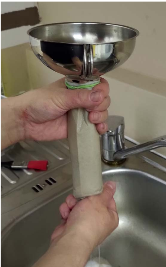
Bild 37: Fraktionierung der Kleinstfraktion < 0,3 mm (© N. Wagner / LELF)
