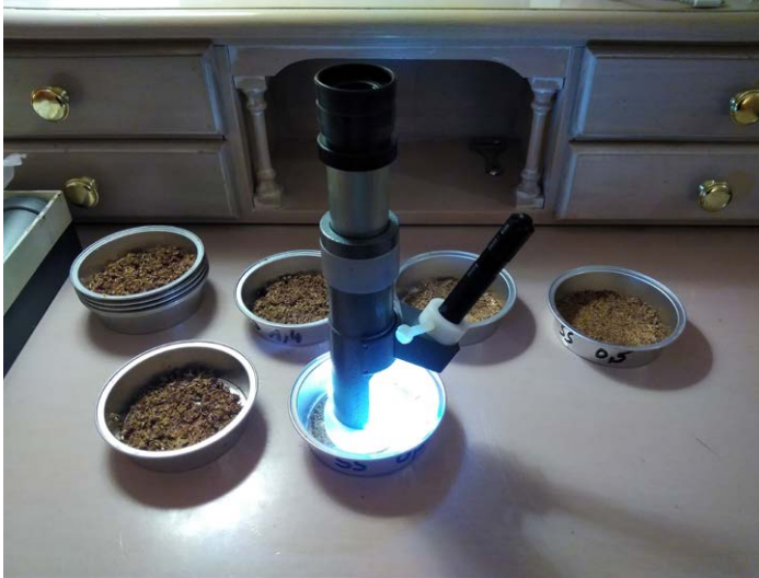
Bild 1: Optische Untersuchung getrockneter Einzelproben mit einem Messmikroskop (© Dr. M. Böckelmann)
