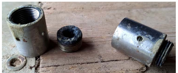
Bild 29: Verkalkte und korrodierte Befeuchtungseinheit der Mikrosuhle (© J. Schäler / LELF)
