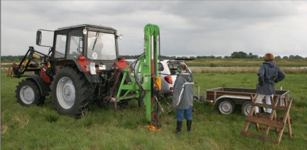
Erkundung einer Beobachtungsfläche mit Hilfe der Rammkernsondierung.
