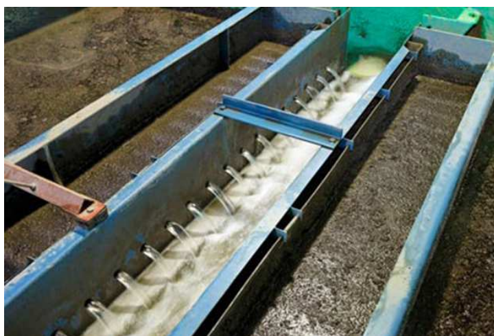
Betrieb einer Bodenwaschanlage
