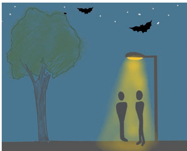
Abbildung 48: Insektenfreundliche Beleuchtung: Waagrecht montierte Leuchten, ohne Abstrahlung nach oben und zur Seite, warmweißes Licht mit Farbtemperaturen von 1800 bis maximal 3000 K
