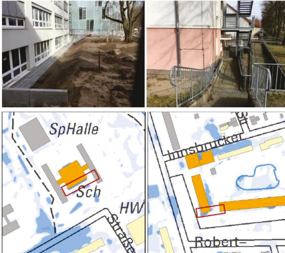
Abbildung 6-3: Starkregenrisiko Tohorst-Gesamtschule (links) und Medizinisches Versorgungszentrum Oranienburg (rechts); Maximale Wassertiefen bei N100 und Starkregenrisiko (gelb = gering, orange = mittel, rot = hoch). Fotos: Hydrotec, 17.03.2020
