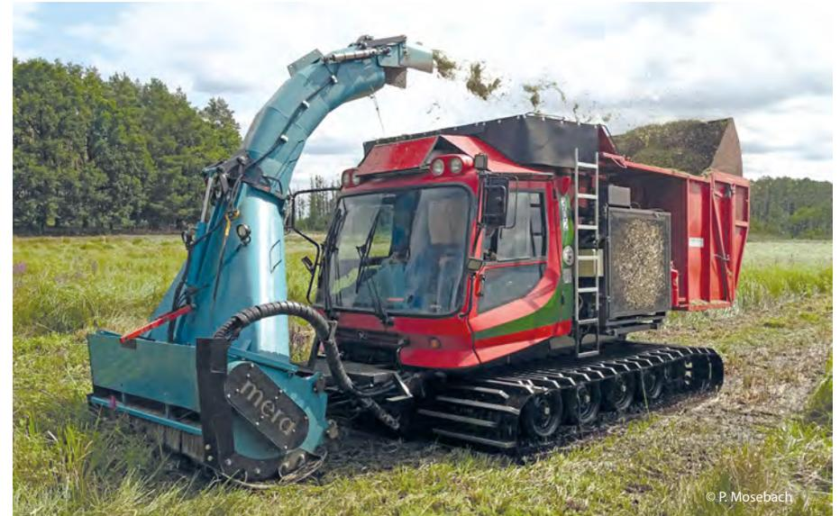
Raupenbasierte Spezialtechnik: Moorraupe mit Mähwerk und Biomassebunker
