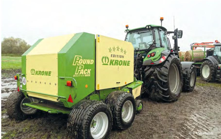
Angepasste Standardtechnik: Breitreifen am Traktor und Tandemachse an der Ballenpresse
