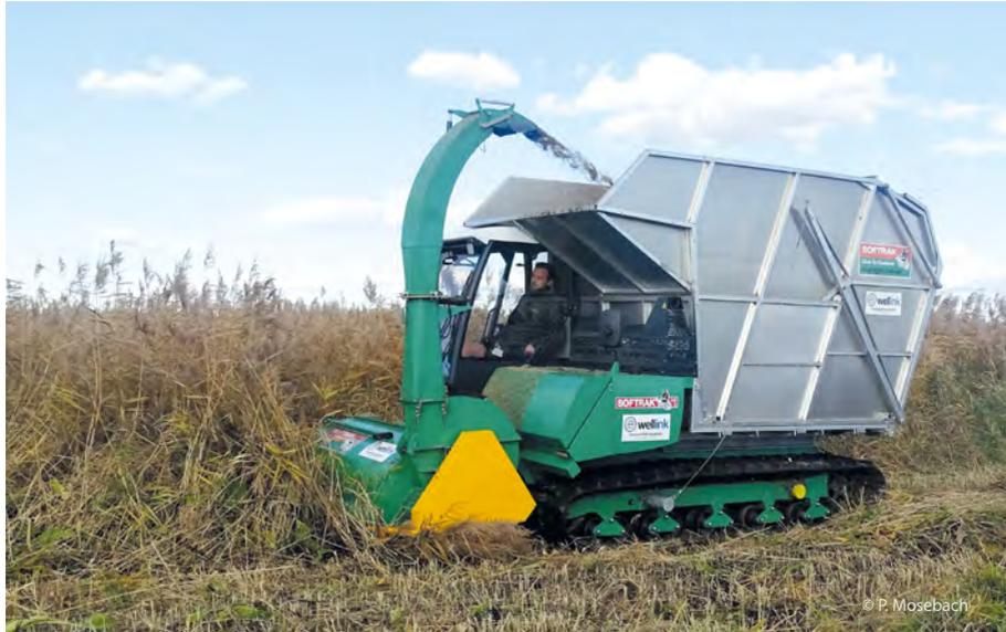
Raupenbasierte Spezialtechnik: Spezialraupe mit Mähwerk und Biomassebunker
