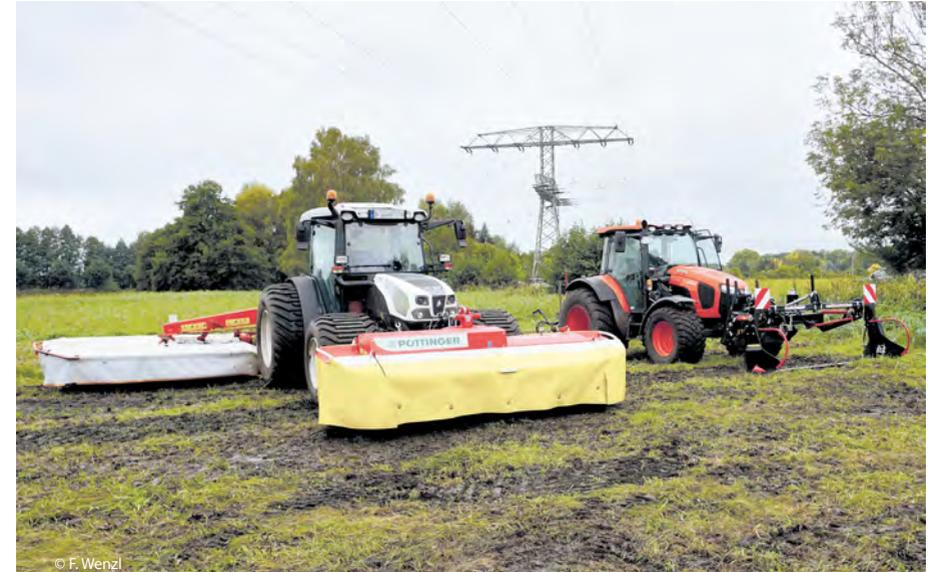
*Angepasste Standardtechnik: Leichte Traktoren mit Breitreifen*
