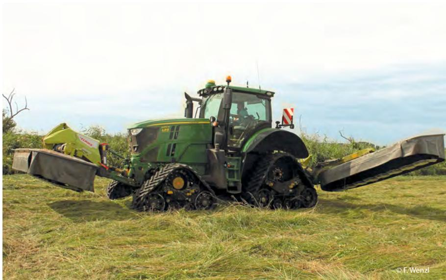
Angepasste Standardtechnik: Traktor mit Delta-Laufwerken
