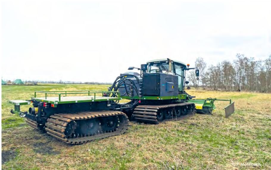
Raupenbasierte Spezialtechnik: Spezialraupe mit Mähwerk und Knicklenkung
