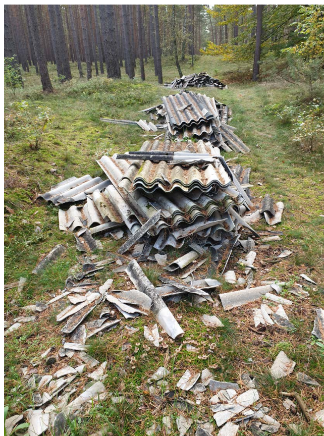
Abb. 2 Gefährlicher Abfall: Asbestplatten (Foto: J. Ecker)
