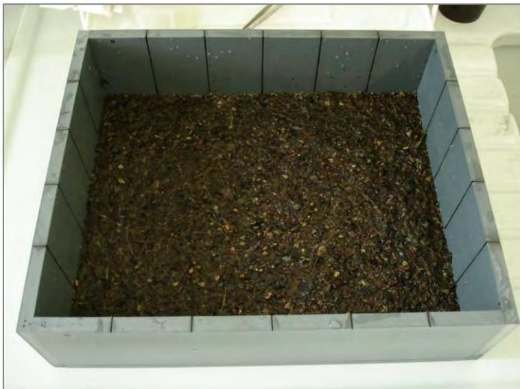
**Abbildung 5: Unterprobensieb mit homogenisierter Probe**
