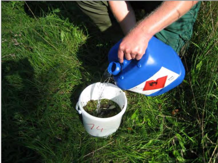
**Abbildung 2: Konservierung einer Probe mit Ethanol**
